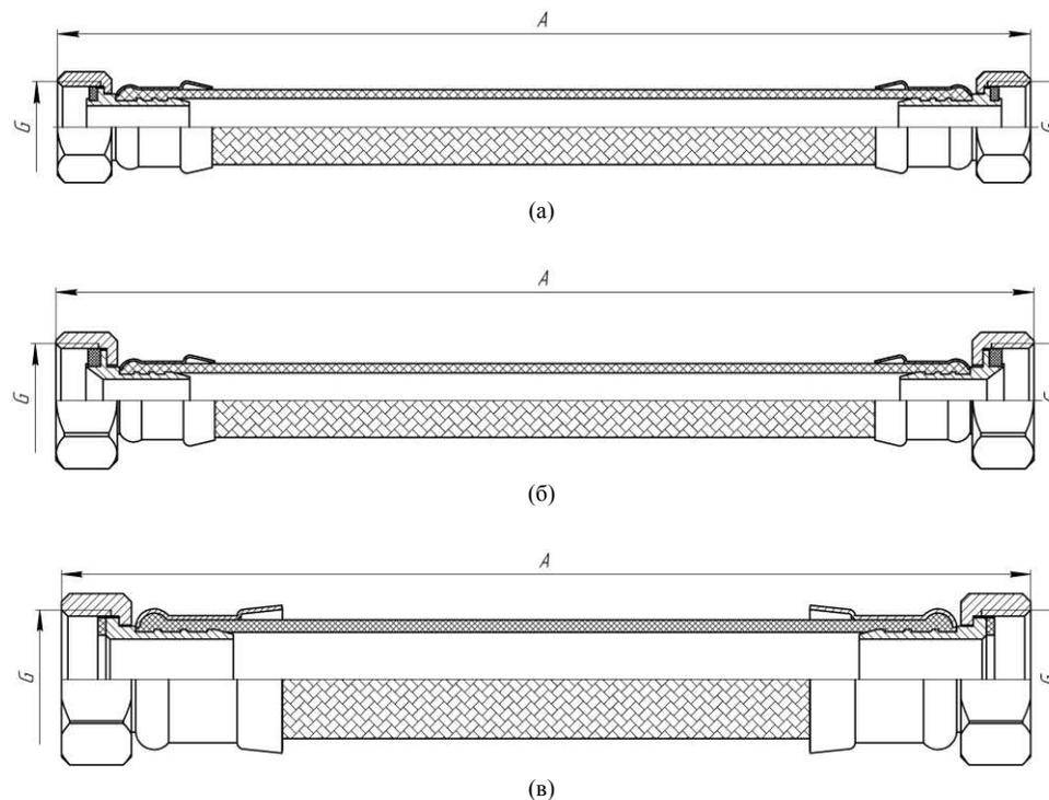
**Рисунок 5** – Габаритные и присоединительные размеры подводки вн-вн: а – ½", б – ¾", в – 1".
