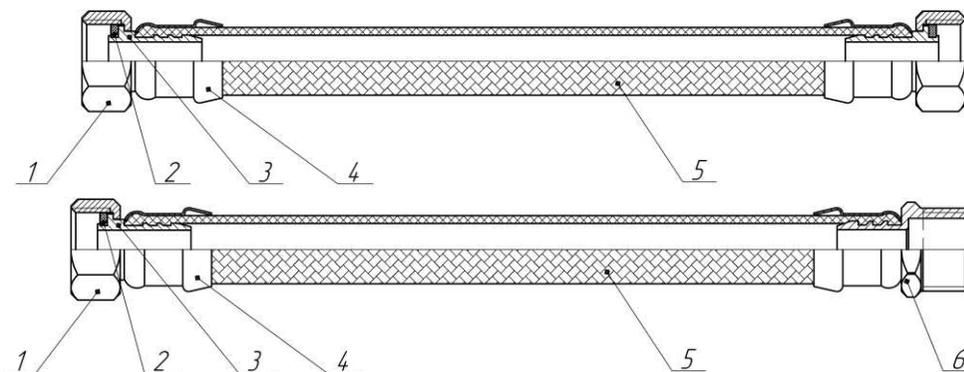
**Рисунок 1** – Общий вид и конструкция подводки 1/2 "
