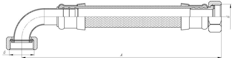
Рисунок 7 – Габаритные и присоединительные размеры подводки вн-вн, угловая
