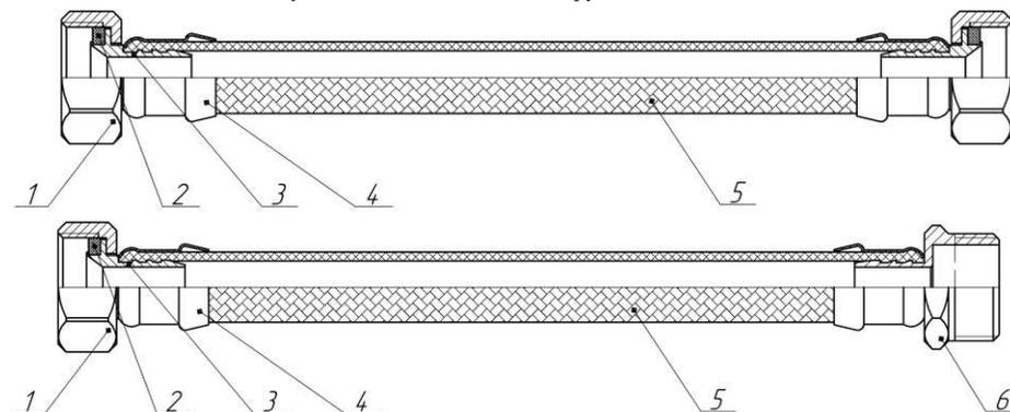
**Рисунок 2** – Общий вид и конструкция подводки 3/4 "
