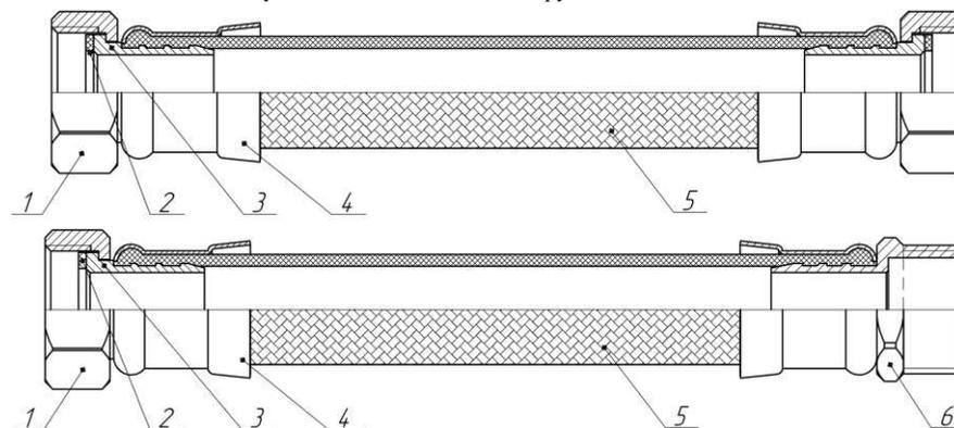
**Рисунок 3** – Общий вид и конструкция подводки 1 "
