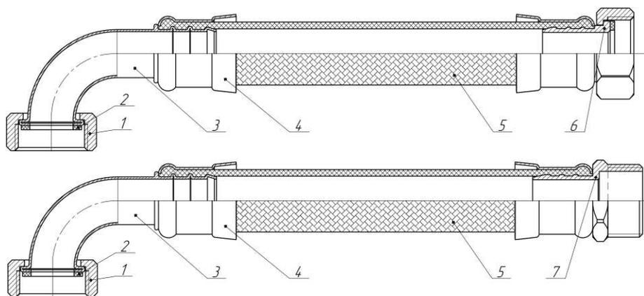
**Рисунок 4** – Общий вид и конструкция подводки 1", угловая
