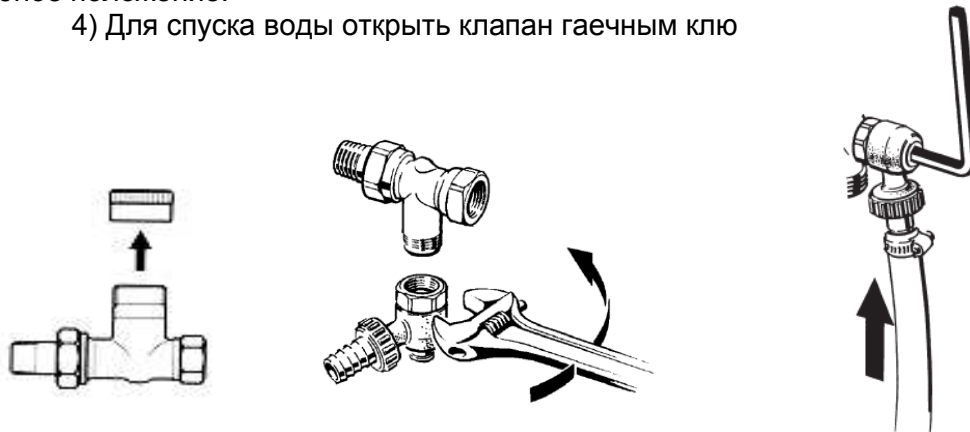
Рис. 3. Монтаж спускного крана.
