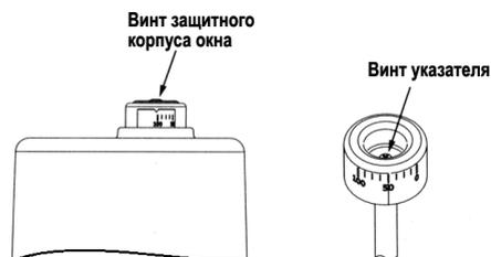
Для удобства считывания информации указатель положения и защитный корпус окон могут регулироваться при помощи винтов крепления.
