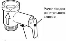
Выпускное отверстие предохранительного клапана
