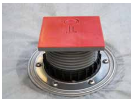
5. Фильтрующий слой зажимается между крепежным фланцем (HL83.0) и надставным элементом (HL85N), устанавливается дренажное кольцо (HL180), в которое - устанавливается надставной элемент трапа, подрезанный по уровню „чистового“ покрытия. Сверху устанавливается монтажная заглушка.
