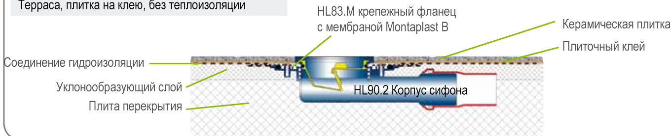
Терраса, плитка на клею, без теплоизоляции
