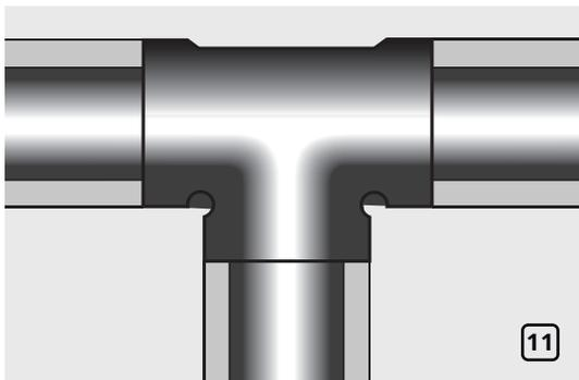
В случае, если Т-фитинг имеет больший диаметр, чем примыкающие к нему трубы, то сначала выполните изоляцию примыкающих к соединению труб меньшего диаметра. Вплотную придвиньте трубки K-FLEX к Т-фитингу и приклейте их внутреннюю поверхность к трубам (рис. 11).
