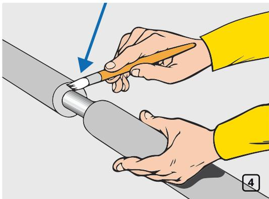
Для соединения трубок между собой необходимо нанести клей K-FLEX K-404 на торцы, затем соединить их и плотно прижать склеенные детали (рис. 4-5).
