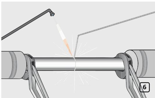
В случае проведения сварочных работ для соединения трубопровода необходимо освободить место для сварки (300–400 мм), при этом теплоизоляцию следует накрыть негорючим материалом (рис. 6).
