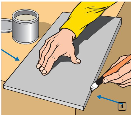
Нанесите равномерный тонкий слой клея K-FLEX K-404 на подлежащие склеиванию торцы листовой изоляции (рис. 4).
