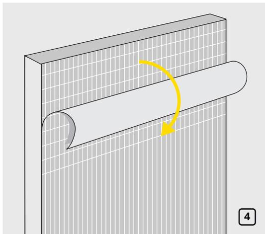
При использовании самоклеящегося материала выполняйте очистку поверхностей и монтаж изоляции в соответствии с инструкциями по несамоклеяемому материалу. Отличие состоит в удалении защитной пленки перед приклеиванием на поверхность воздуховода (рис. 4).
