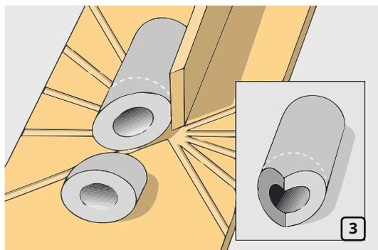
Трубку «примыкания» обрезать под двойным углом  $45^\circ$  (рис. 3).
