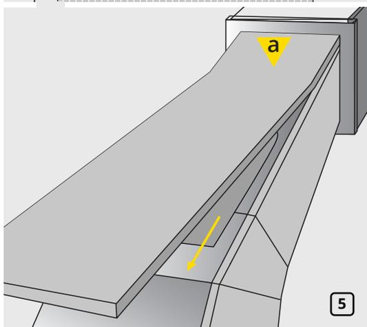
Аккуратно отклейте защитную пленку с одного конца теплоизоляционного листа и закрепите этот конец на поверхности воздуховода в исходной позиции (а). Постепенно удаляйте защитную пленку и прижимайте самоклеящийся материал к изолируемой поверхности.
