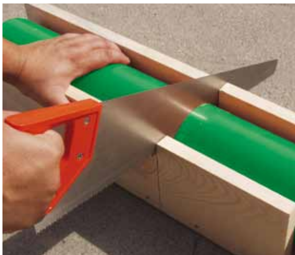
Рис. 3 Резка с использованием стусла
