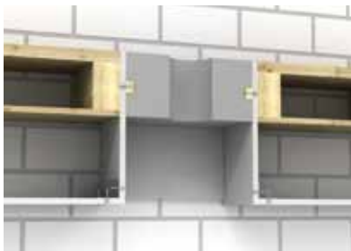
Перекрытие с деревянными балками с подшивным потолком
