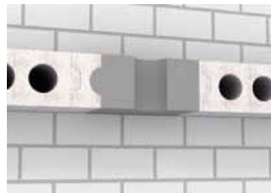
Перекрытие из пористого бетона (возможно с пустотами)
