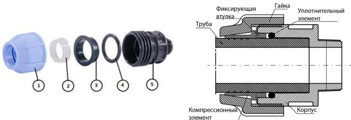
2.2 Составные части фитинга (кроме уплотнительного кольца) производятся методом литья под давлением.
