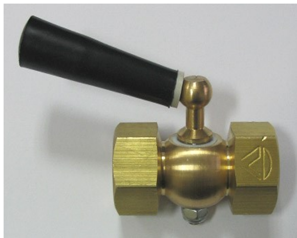
Кран трехходовой без фланца с ручкой исполнение 3 (патрубки с внутренней резьбой)
