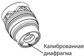
При установке клапана Cim 790 балансировка расхода достигается автоматически, независимо от колебаний давления в системе.
